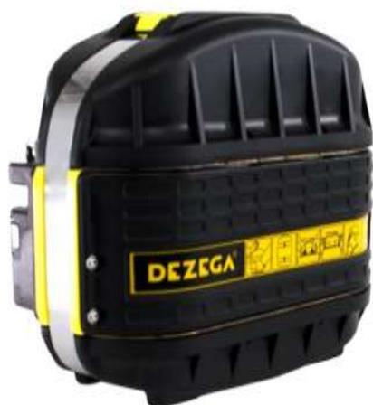
Le CARBO 30 est un appareil d'évacuation à circuit fermé doté d'une grande autonomie. Grâce à son fonctionnement au Superoxyde de potassium (KO<sub>2</sub>) qui régénère l'air expiré en oxygène.
